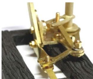
**Hinweis für den Anbau an 5905 und 5906:** Der Arm, der zum Weichenhebel führt, muss an dem Laternenstellhebel so verformt werden, dass beide Arme von der Gelenkachse aus nach oben abgehen. Die beiden zusätzlichen Schrauben dienen zur Befestigung auf der Ecke der Grundplatte.
