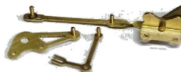
Montieren Sie die 3 Schrauben. Alle drei Schrauben werden von unten eingeschraubt: In die Weichenhebelstange als Mitnehmer, in die Bodenplatte als Drehachse für den Hebel und in den Laternenstellhebel
